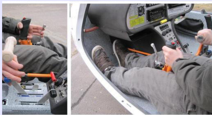
Exemple de dispositif de malonnier
