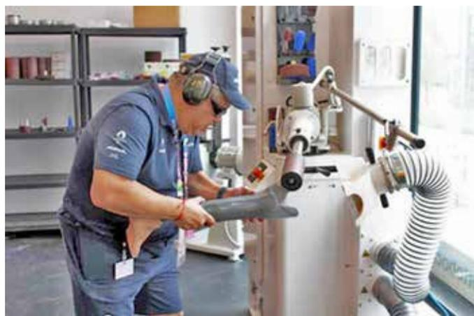
Pour éviter les points de pression, un technicien ponce le bord d'une emboîture.
